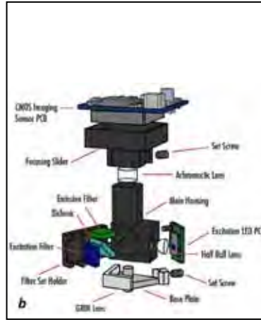
Afbeelding 2: a) muis met miniscope aangesloten aan de computer (foto: C. Canto). De muis kan vrij bewegen in zijn kooi; b) schematische weergave van een miniscope welke bestaat uit een basisplaat met fluorescentie microscoop, GRIN lens en allerlei filters. Base Plate is de basisplaat die op de schedel vast zit. Daarop zit het vaste gedeelte (main housing) waarin de filters en lenzen zitten. Alleen tijdens het meten wordt het vaste gedeelte op de basisplaat gezet. Als een dier niet wordt gemeten, is deze afgekoppeld (8).
