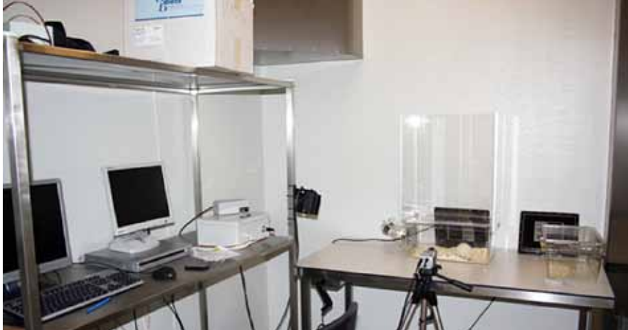
Afbeelding 1. Opstelling voor video-observatie en telemetrie. Rat is gehuisvest in kooi zonder rooster maar met verhoogde zijwanden om ontsnappen te voorkomen.
